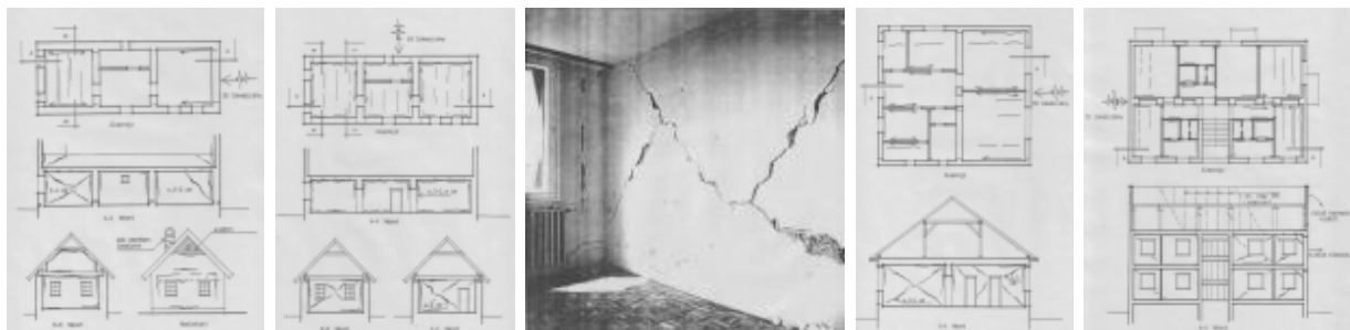
Berhida, Peremarton, károsodások ábrázolása a lökésirány és az épülettípusok szerint
