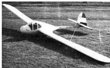
R-15 KOMA egymás melletti ülésű, kétkormányos iskolagép, sorozatban készült 1950-ben
