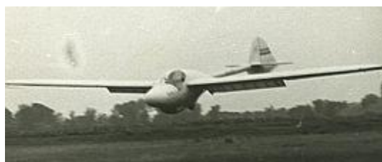
R-15 KOMA egymás melletti ülésű, kétkormányos iskolagép, sorozatban készült 1950-ben
